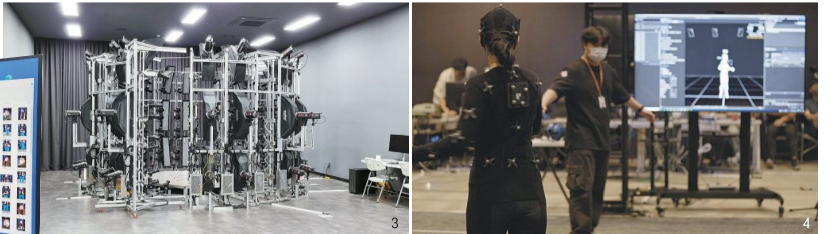
1 지난달 데뷔한 4인조 버추얼 아이돌 메이브. 최초의 'K팝 웹툰' 등 엔터산업에서 새 영역을 개척하고 있다. 2, 3, 4 메이브를 만든 버추얼 아바타 제작 과정. 바디스캐닝으로 만든 하이퍼리얼 3D 모델에 모션캡처 방식으로 움직임을 입힌다. [사진 메타버스엔터테인먼트]
