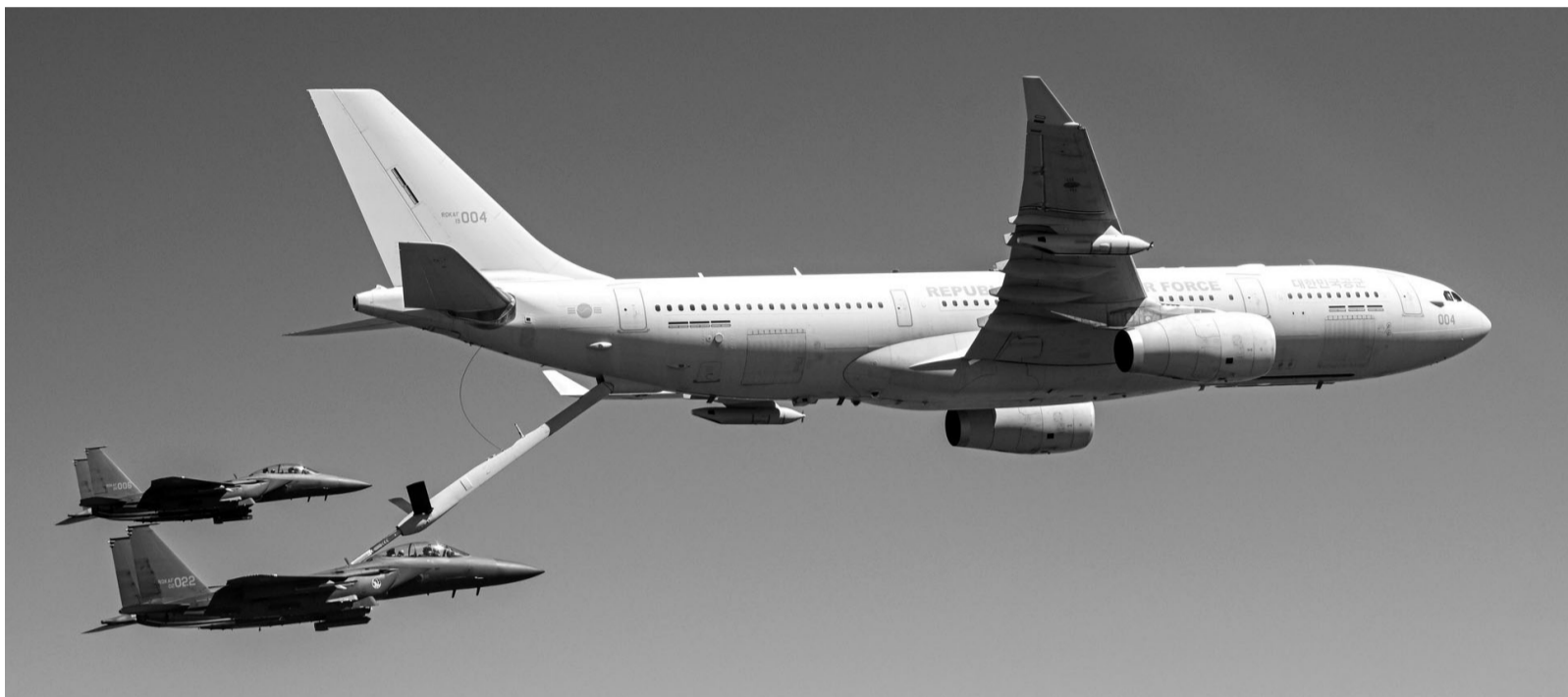
F-15K에 공중급유 시도하는 KC-330. 지난 12일 공군 KC-330 공중급유기가 후미로 진입한 F-15K 전투기에 급유 붐을 길게 내려 공중급유를 시도하고 있다. 3차원 입체 공간에서 290노트(knot, 시속 약 530km)를 넘는 속도로 비행하는 두 대의 항공기가 지름 약 10cm의 급유구를 서로 맞닿게 시도하는 순간은 모든 공중급유 임무 요원들이 가장 긴장하는 순간이다. <공군 제공>
