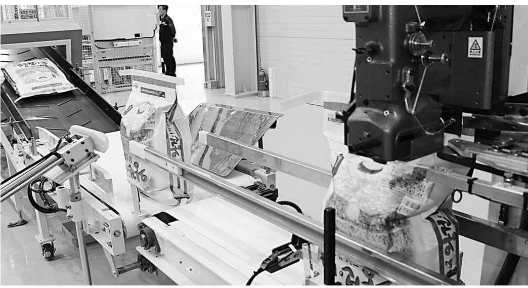
나주 동강면에 최근 지어진 '나주시 통합 미곡종합처리장(RPC)'은 시간당 정곡 10t, 연간 최대 2만t을 생산할 수 있는 전국 최대 규모 가공 현대화 시설이다. <나주시 제공>
