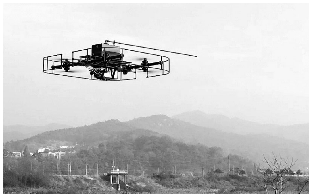
나주 상공에서 악취 분석을 위해 대기를 포집하고 있는 드론 모습. (나주시 제공)
