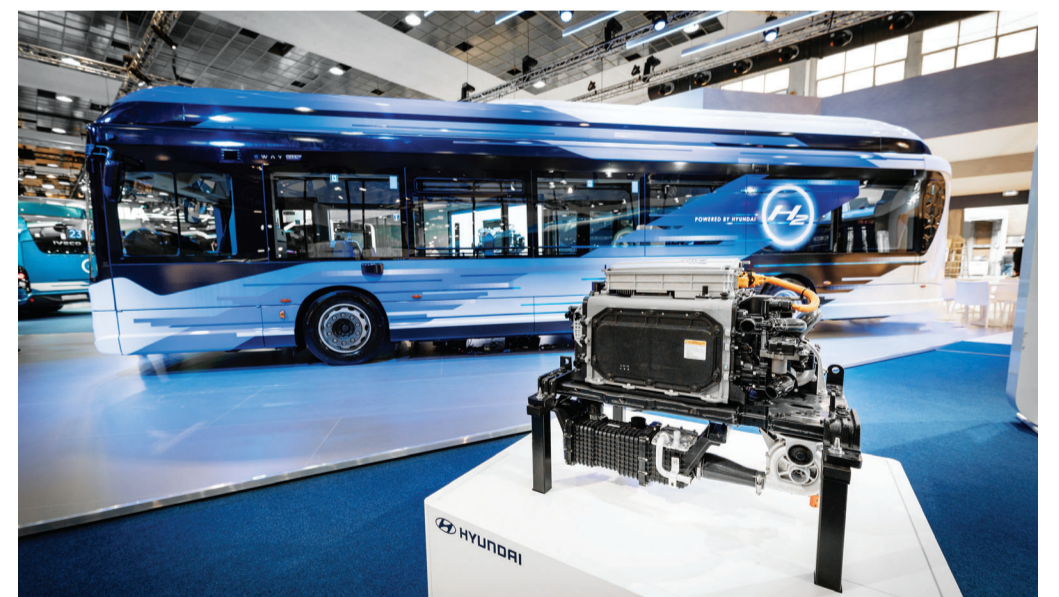
버스월드 2023 이베코버스 부스에서 전시 중인 수소전기 시내버스 'E-WAY H2'와 버스에 탑재된 현대자동차의 수소연료전지시스템. <현대차 제공>
