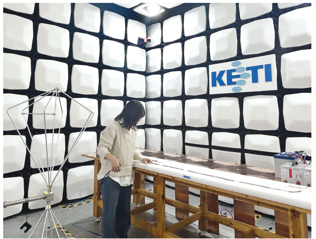
광주시 북구 첨단지구 내에 있는 KETI 광주지역본부 주관 DC전기전자산업육성센터(KOLAS 국제공인 시험기관)에서 한 연구원이 자동차 램프 GSM·무전기 주파수 내성 시험을 하고 있다.
