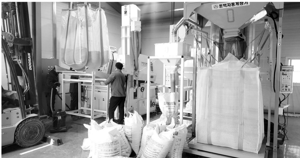
화순군 농업기술센터 농주면 농기계임대사업소에서 최근 도입한 1t들이 콩 정선기로 정선을 하는 모습. <화순=배영재 기자 byj@kwangju.co.kr>
