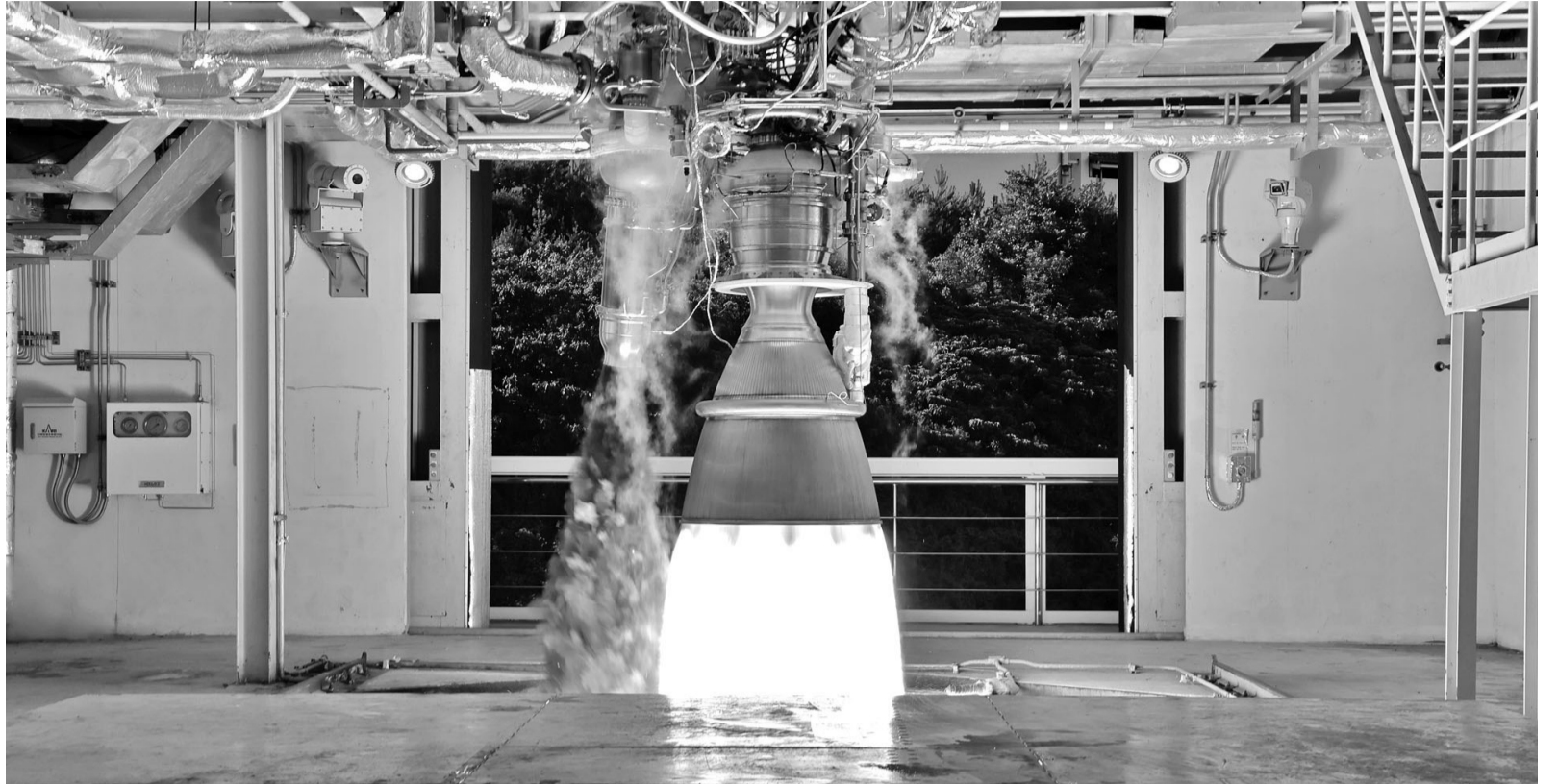
누리호 4차 발사 준비...첫 연소시험 내년 하반기에 예정된 한국형발사체 누리호가 첫 엔진 조립을 마치고 첫 연소시험을 시행했다. 우주항공청과 한국항공우주연구원은 지난 3일 누리호 4차 발사를 위한 1단 용 75t급 엔진 조립을 완료하고 고흥 나로 우주센터에서 엔진 성능검증 수막 연소시험을 진행했다고 4일 밝혔다. 누리호 4차 발사 비행모델(FM) 1단 엔진 수막 시험 장면. <우주항공청 제공>
