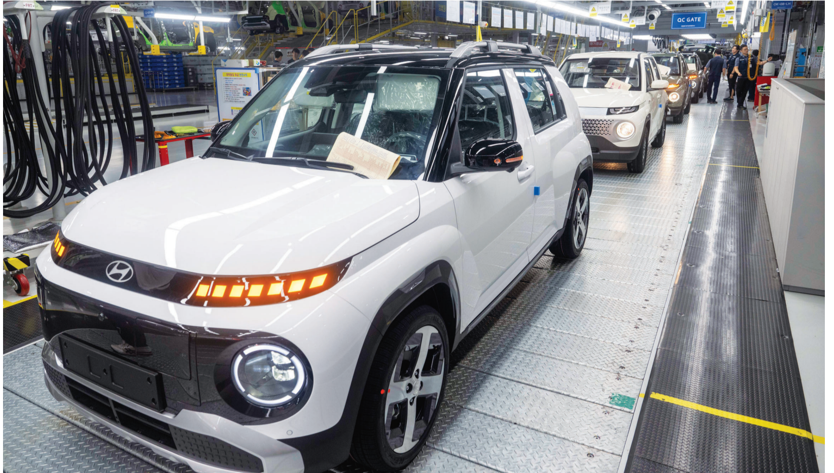
광주글로벌모터스(GGM)가 13일 캐스퍼 EV의 생산라인을 공개했다. GGM은 이날부터 8월 한 달간 전기차를 주력 생산해 하루 234대를 출하한다. 사진은 캐스퍼 EV 조립 공정라인에 차량들이 조립되고 있는 모습. /김진수 기자 jeans@kwangju.co.kr
