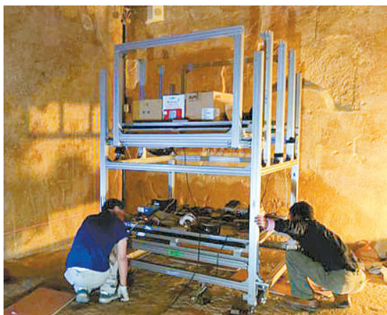
일본·프랑스 등 국제연구진이 뮤온 입자를 이용해 이집트 대피라미드 내부를 탐사하고 있다. [중앙포토]
